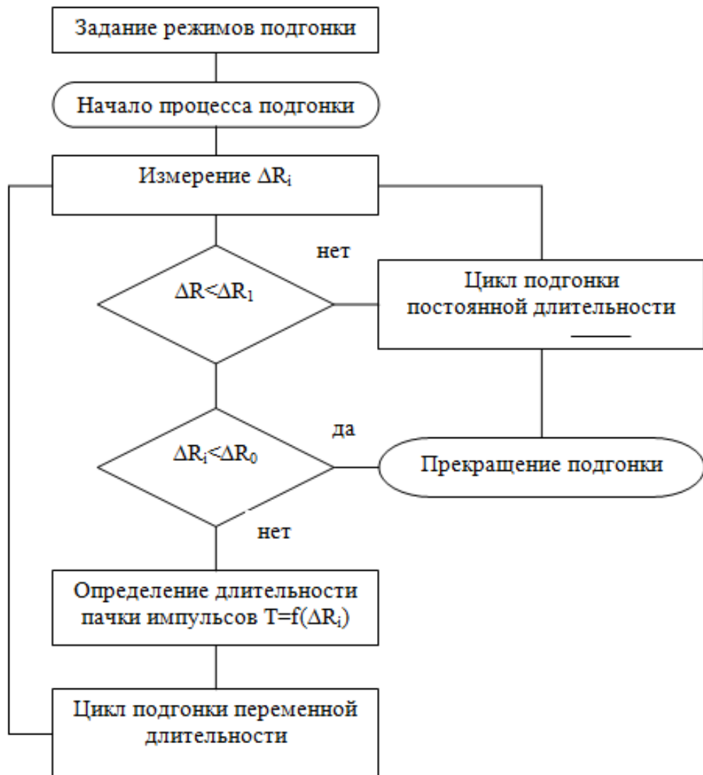
Рис. 3. Алгоритм процесса подгонки с изменяемой длительностью пачки импульсов
