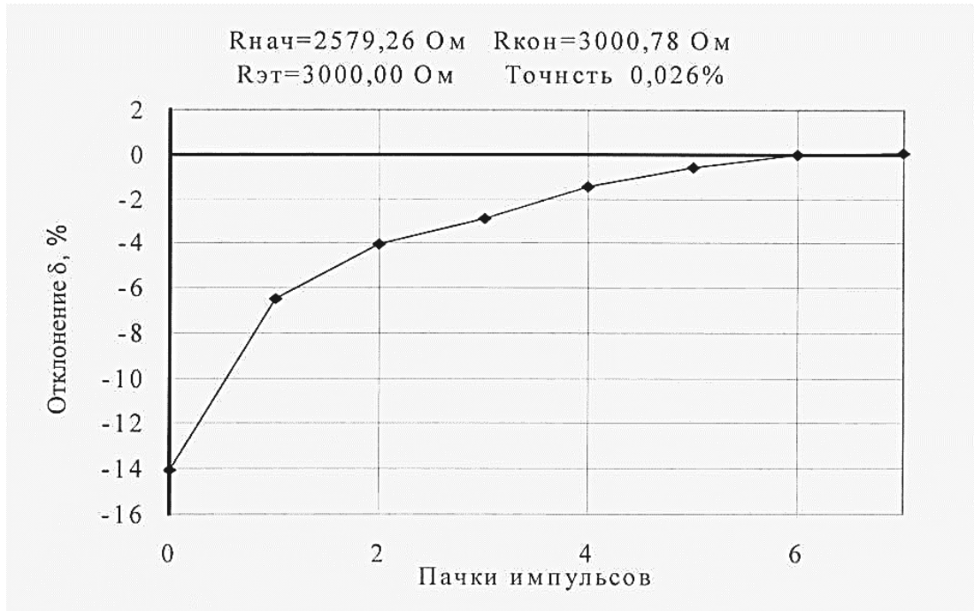
Рис. 5. Изменение величины приращения сопротивления в зависимости от номера пачки импульсов
